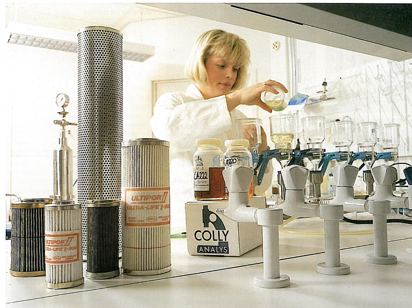
Pallfiltrets status kontrolleras kontinuerligt av Colly Companys avdelning för teknisk service. Livs- och läkemedelstillverkning kräver sterilt och partikelfritt vatten.
